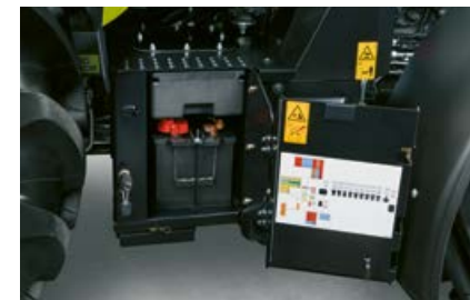
Rechts im Aufstieg finden Sie gut zugänglich die Batterie, das Werkzeugfach und einen Druckluftanschluss.
