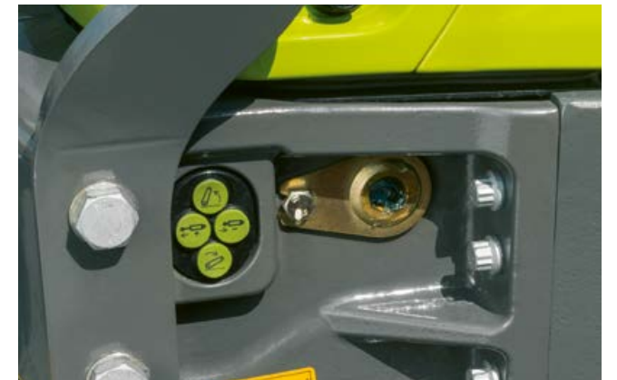
Mit elektronischen Steuergeräten können der Frontkraftheber und das zusätzliche Steuergerät auch extern bedient werden.
