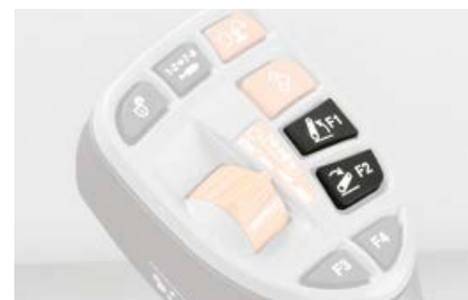
Die Bedienung des Heckkrafthebers kann nicht nur über die Seitenkonsole erfolgen, sondern auch über den Multifunktionsgriff.
