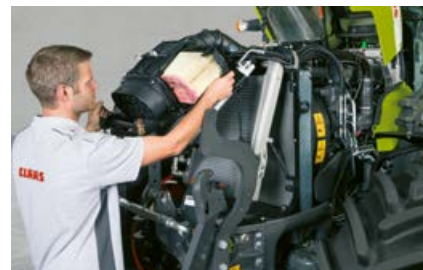
Der Motorluftfilter ist vor den Kühlern eingebaut und lässt sich leicht reinigen.
