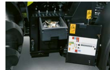
Rechts im Aufstieg finden Sie gut zugänglich die Batterie, das Werkzeugfach und einen Druckluftanschluss.
