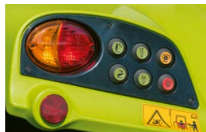
Bedienung von Heckkraftheber, elektronischem Steuergerät und Zapfwelle auf beiden Kotflügeln möglich. Am linken Kotflügel ist ein Halter für vier Unterlenkerkugeln vorhanden.
