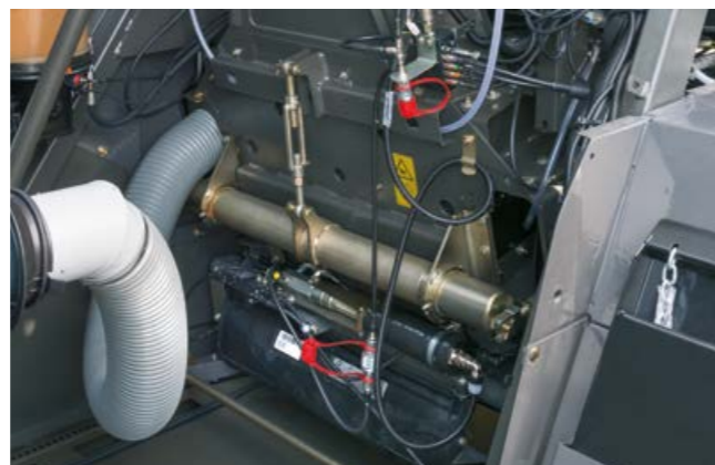
Mechanische Spalteinstellung des Auswurfbeschleunigers
