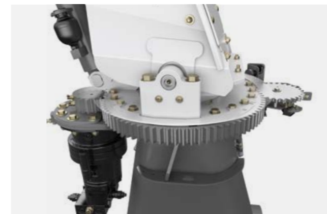
Robuster Drehkranz für Ernteeinsätze speziell bei Hanglagen oder hohen Geschwindigkeiten
