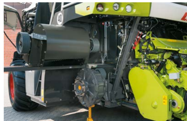
Einfacher Aus- und Einbau des Beschleunigers
