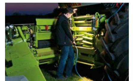
Le QUICK ACCESS permet l'inspection des organes de coupe en quelques minutes seulement.
