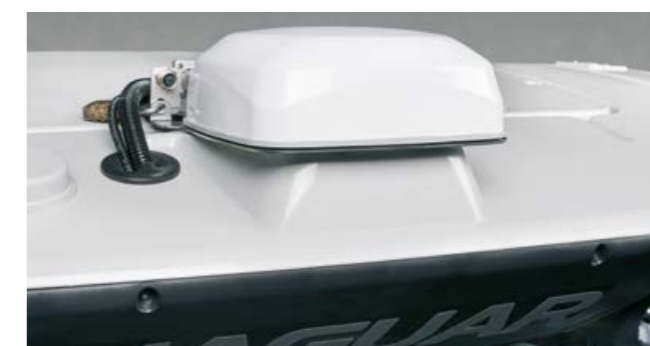
SAT 900, antenna e ricevitore integrati con protezione antifurto
