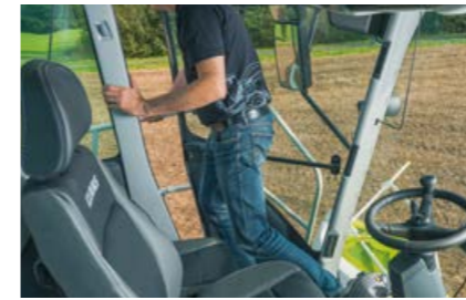
L'interruttore del sedile disattiva automaticamente la testata e la trasmissione principale.
