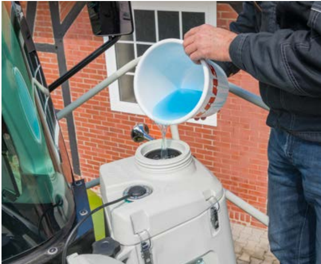
Remplissage du réservoir d'additifs d'ensilage
