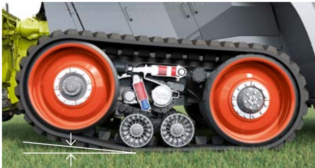
Surface de contact au sol réduite de 66 % : une partie des chenilles se relève jusqu'à 100 mm.
