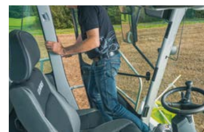
Le détecteur de présence arrête automatiquement l'outil et l'entraînement principal.
