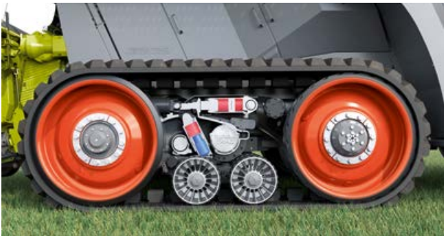
Surface de contact au sol totale de 100 % : les chenilles touchent entièrement le sol.
