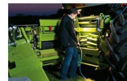
Le QUICK ACCESS permet l'inspection des organes de coupe en quelques minutes seulement.
