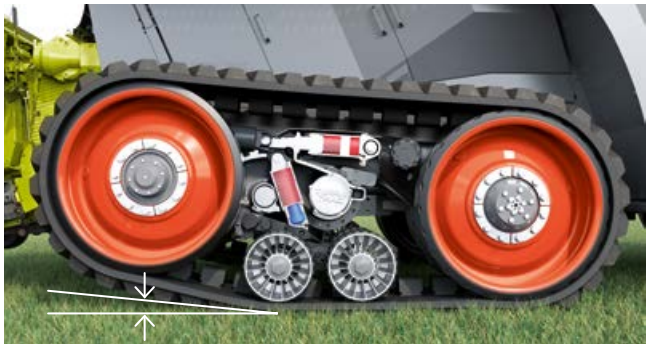
66 % de superficie de apoyo: El rodillo de rodaje se eleva hasta 100 mm.
