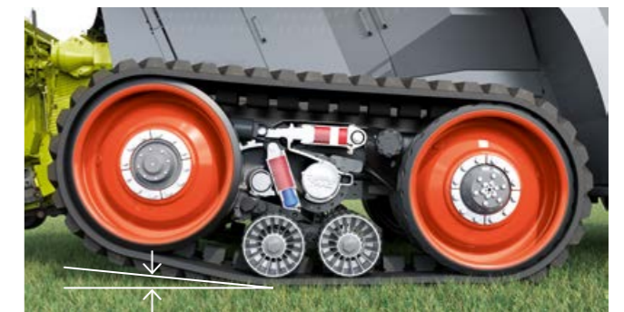
66 % de superficie de apoyo: El rodillo de rodaje se eleva hasta 100 mm.
