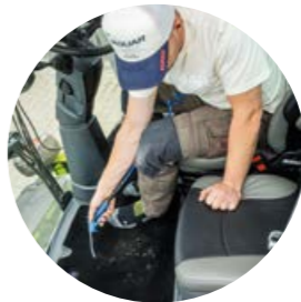
Pistola de aire comprimido en la cabina para la limpieza
