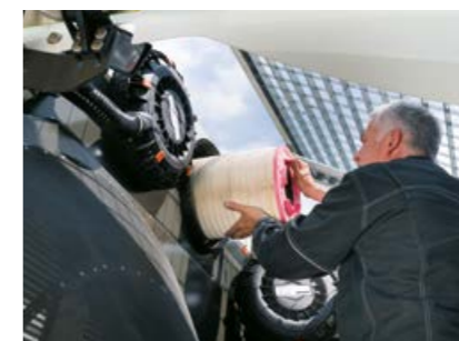
Cambio del filtro de aire sin herramientas
