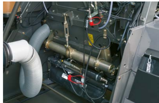
Ajuste mecánico de la abertura del acelerador de la descarga
