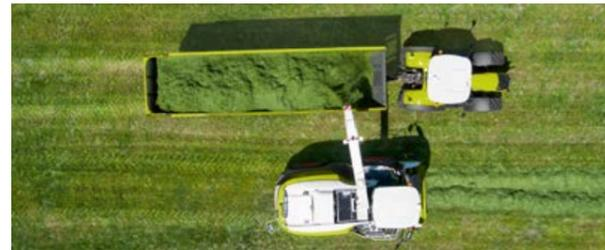
Dos posiciones del codo programables de forma fija le facilitan el proceso de giro en cabecera. Además, el codo de descarga se puede colocar, pulsando un botón, automáticamente en la posición de reposo.
