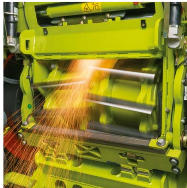
**Fijar hidráulicamente la contracuchilla.**
