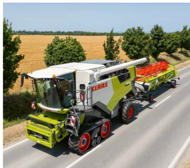
Wszystkie gąsienice TERRA TRAC nadają się do jazdy po drodze z prędkością maks. 30 km/h. Można z nich wygodnie korzystać jak w przypadku maszyn na kołach.
