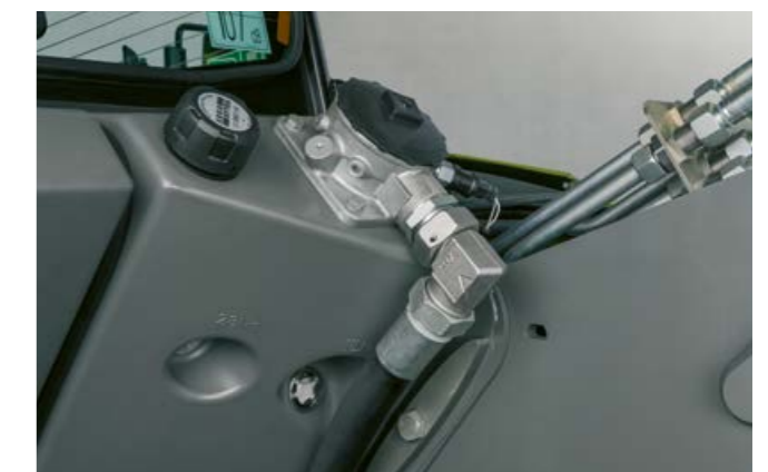
Hydraulikkoljenivået kan enkelt kontrolleres via et nivåglass. Hydraulikksystemet beskyttes av et returfilter. Skift filteret først etter 1000 driftstimer.
