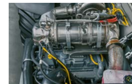
Dieselpartikkelfilteret regenereres automatisk.
