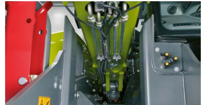
Sideføringene er integrert som standard i rammen for alle teleskoplastere med en lastekapasitet på over 4500 kg.
