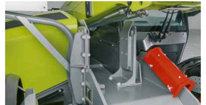
Sideveis støtte av teleskopbommen er tilgjengelig på alle SCORPION-modeller.
