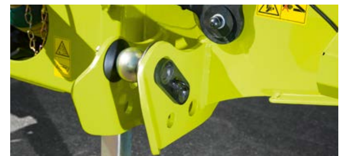
Trekkstangføringer og fanghaker for lett vint tilkobling.
