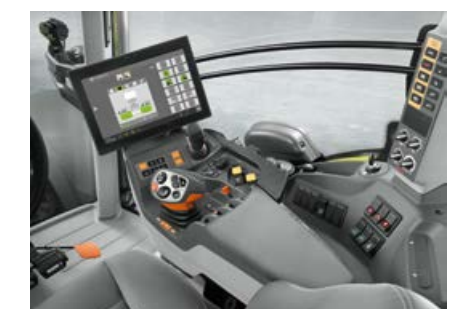
Hvis traktoren er utstyrt med en ISOBUS-kompatibel terminal, kan forhåndsvalgt betjening for CONTOUR utføres direkte via denne.
