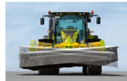
Det frie pendeloppheget sørger for perfekt tilpassning også i tverretningen.
