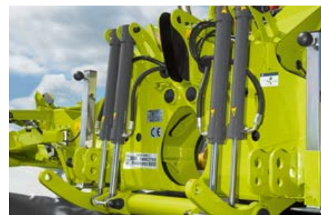
ACTIVE FLOAT løfte- og avlastingssylinder er standard. Systemet gir slåmaskinen en meget god tilpasning til underlaget.
