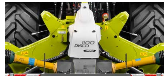
Kompakt, kraftig og stabil tilkoblingsramme med integrert ACTIVE FLOAT vektavlastning som standard.
