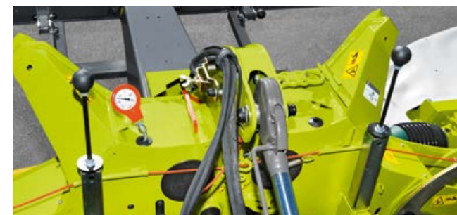
Et lett synlig manometer gjør det enkelt å justere marktrykket for begge enhetene.
