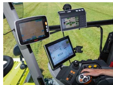
Enkel i bruk med f.eks. ISOBUS-terminal og ISOBUS funksjonstaster på kjørespaken.
