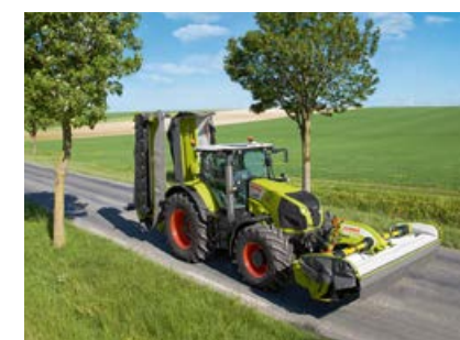
Kompakt transportstilling øker sikkerheten langs veien.
