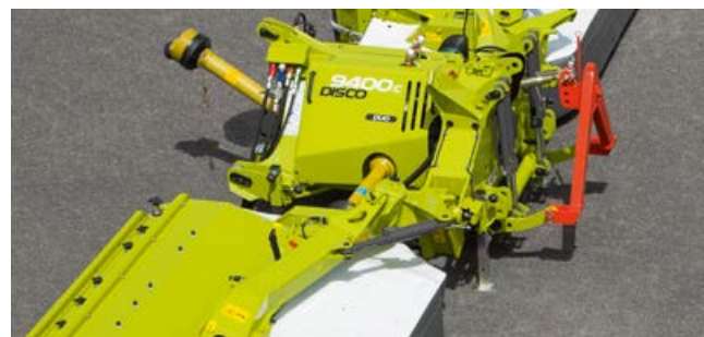
Non-stop, hydraulisk påkjøringssikring ved en evt. påkjørsel. Maskinen svinger oppover og bakover og går automatisk tilbake til utgangsposisjonen.
