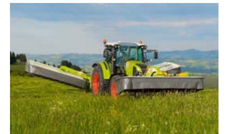
Det kompakte opphenget for trepunktshydraulikken foran gjør at maskinen kan løftes høyt på vendeteigene.
