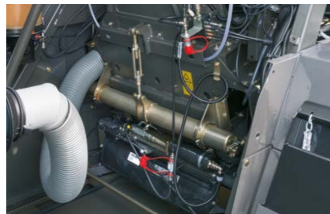
Mechaniczne ustawianie szczeliny przyspieszacza wyrzutu
