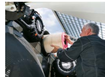
Wymiana filtra powietrza bez użycia narzędzi
