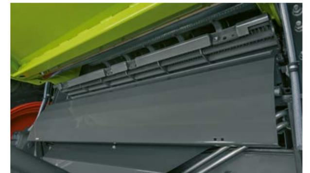
凹型セグメントは、石除けストラップを使用して簡単に引き出すことができます。
