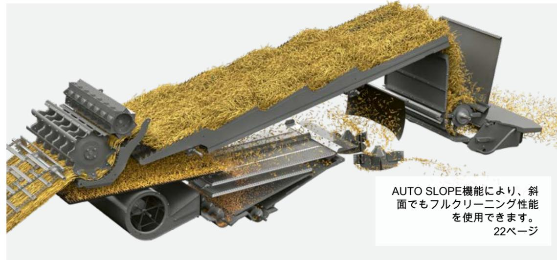
AUTO SLOPE機能により、斜面でもフルクリーニング性能を使用できます。
