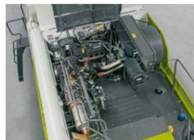
Cumminsエンジン、AdBlueを用いた排気ガスの後処理 (ステージV)
