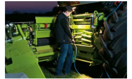
QUICK ACCESS macht die Inspektion der Häckslerorgane in wenigen Minuten möglich.
