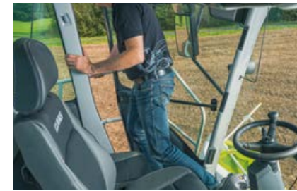
Der Sitzschalter schaltet Vorsatz und Hauptantrieb automatisch aus.
