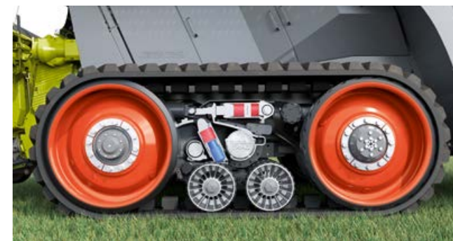
100% Aufstandsfläche: Die Laufrolle hat vollen Kontakt zum Boden.
