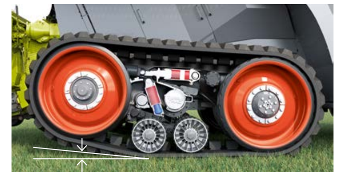
66% Aufstandsfläche: Die Laufrolle wird bis zu 100 mm angehoben.
