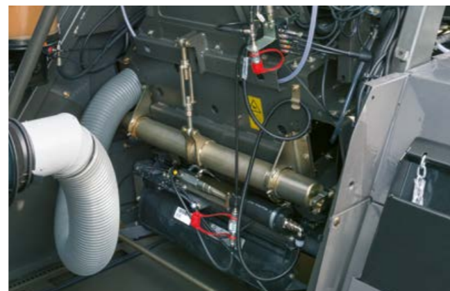
Reglare mecanică a distanței acceleratorului de material recoltat.
