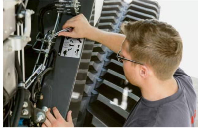
油圧バルブを使用して、脱穀ドラム減速ギアボックスを2つの速度範囲の間で手動で切り替えができます。
