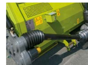
Võimsa jõuülekanedega kolmeastmeline käigukast.
