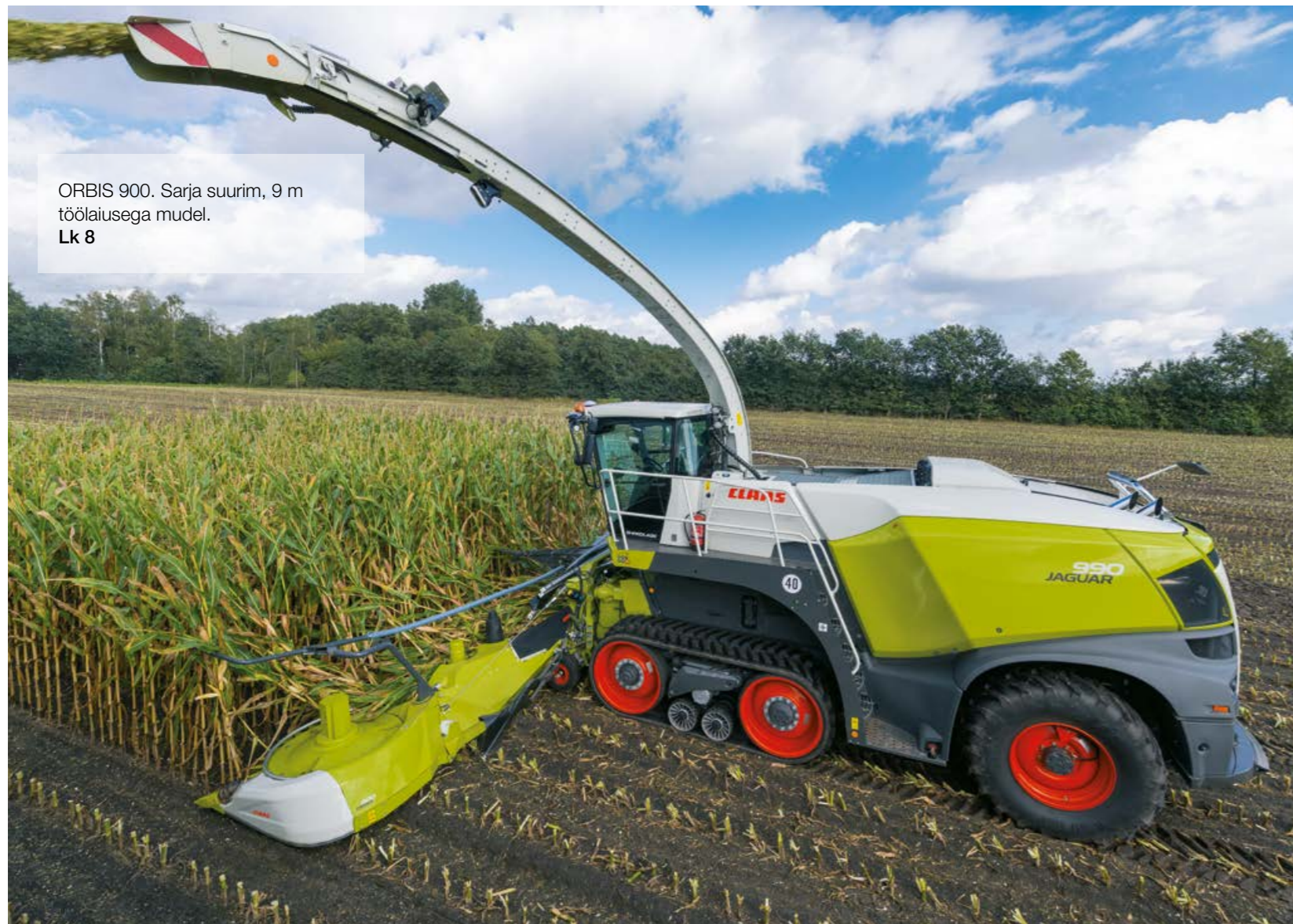
Kiire kokku- ja lahtiklappimine. Juht ei pea enne põllule või maanteele sõitmist kabiinist vahepeal väljuma. Kasutusvalmiduse saavutamiseks kulub maksimaalselt 30 sekundit. Lk 16
