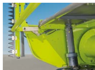
Reguleeritavad pressid (lisavarustuses ka hüdraullised).
