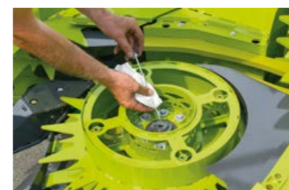
Mõõtevarras õlitamise kontrollimiseks.
