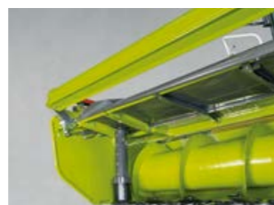
Valtspress, mis tagab väga ühtlase materjali edastamise.
