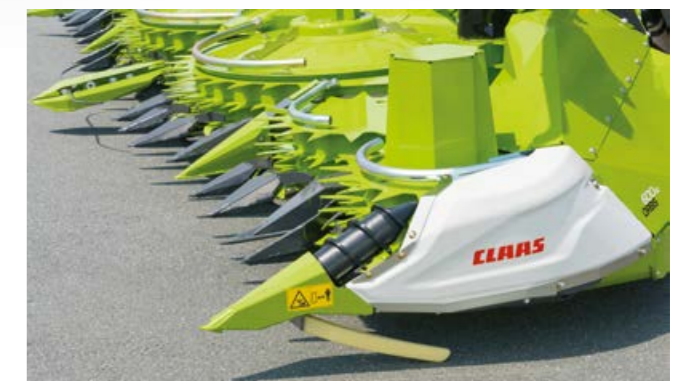
Vajaduse korral käitatakse lamandunud maisi tiguid hüdrauliliselt.
