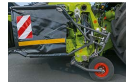
Tiiptasemel sõidumugavuse tagavad aktiveeritud transpordisüsteem ja sisselülitatud vibratsiooni-summutus.
