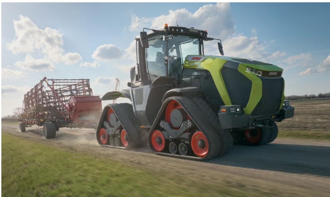
◀ La conception de la suspension, depuis les capacités d'absorption des chocs de l'ensemble des chenilles, à la suspension de la cabine en 4 points et jusqu'au siège haut de gamme rembourré, fait du XERION un véhicule exceptionnellement confortable.
