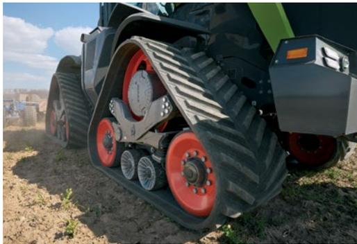
◀ Deux largeurs de bande (914 mm / 36 pouces ou 762 mm / 30 pouces) garantissent une protection maximale du sol. Avec les bandes de chenilles les plus étroites, la largeur totale du XERION est inférieure à 3 m (10 pi).
