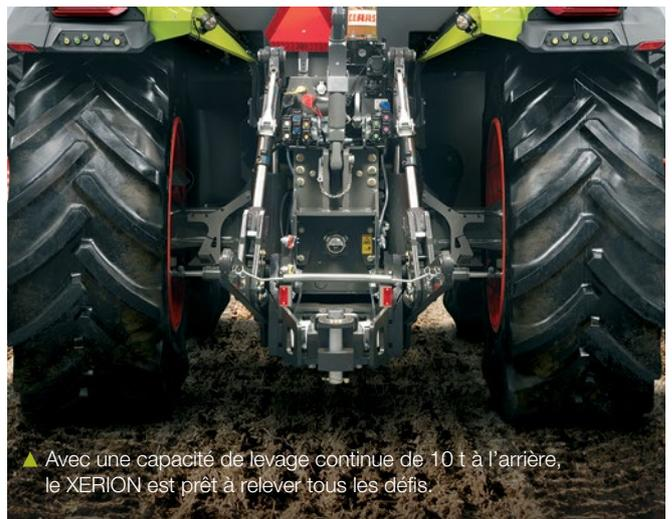
▲ Avec une capacité de levage continue de 10 t à l'arrière, le XERION est prêt à relever tous les défis.
