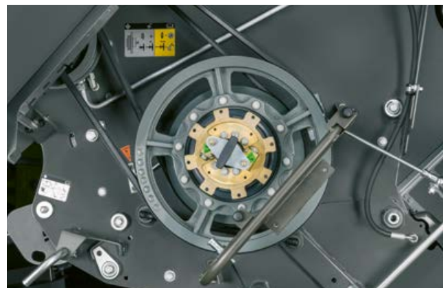
Частота вращения измельчителя соломы просто, быстро и без использования инструментов адаптируется к условиям уборки.
