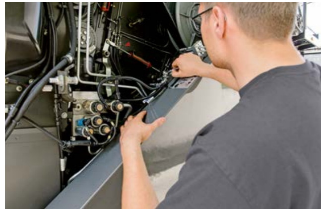
Los dos rangos de revoluciones del engranaje reductor del cilindro desgranador los conecta manualmente con una válvula hidráulica.
