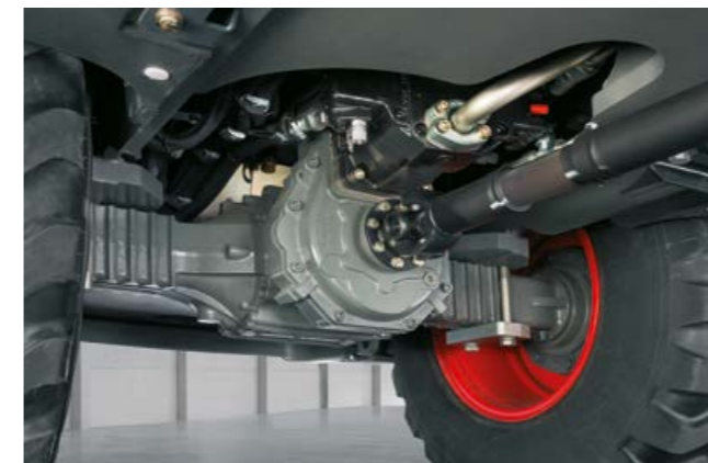
Hydrostatisk framdrivning med automatisk bromsverkan.
