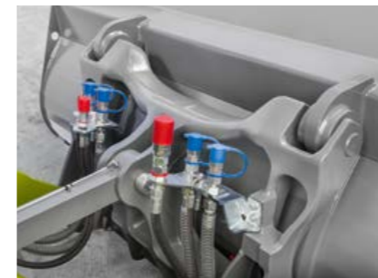
Alla anslutningar är placerade på skyddad plats på redskapsfästet och lätt åtkomliga (956).
