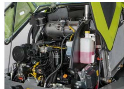
Alla komponenter i motorrummet är lätt åtkomliga.
