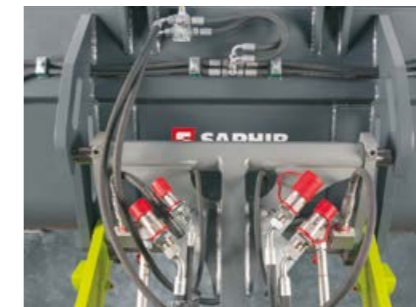
Fri retur framtill och en extra läckoljeledning med anslutning till redskapsfästet (644 / 537).
