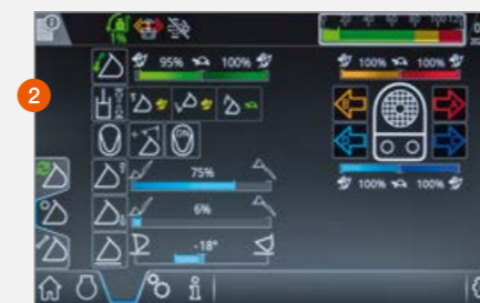
Positioner för begränsning av lyfthöjd och sänkdjup visas på 9" pekskärm.
