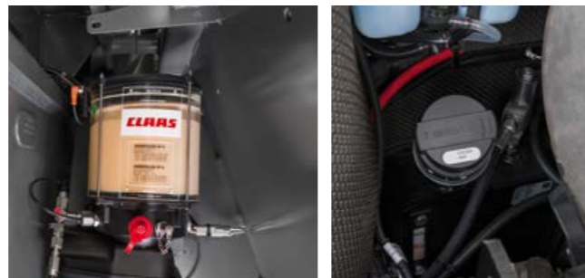
Påfyllningen för hydraulolja är placerad under motorhuven, skyddad för smuts. Väl synligt nivåglas för enkel kontroll.
