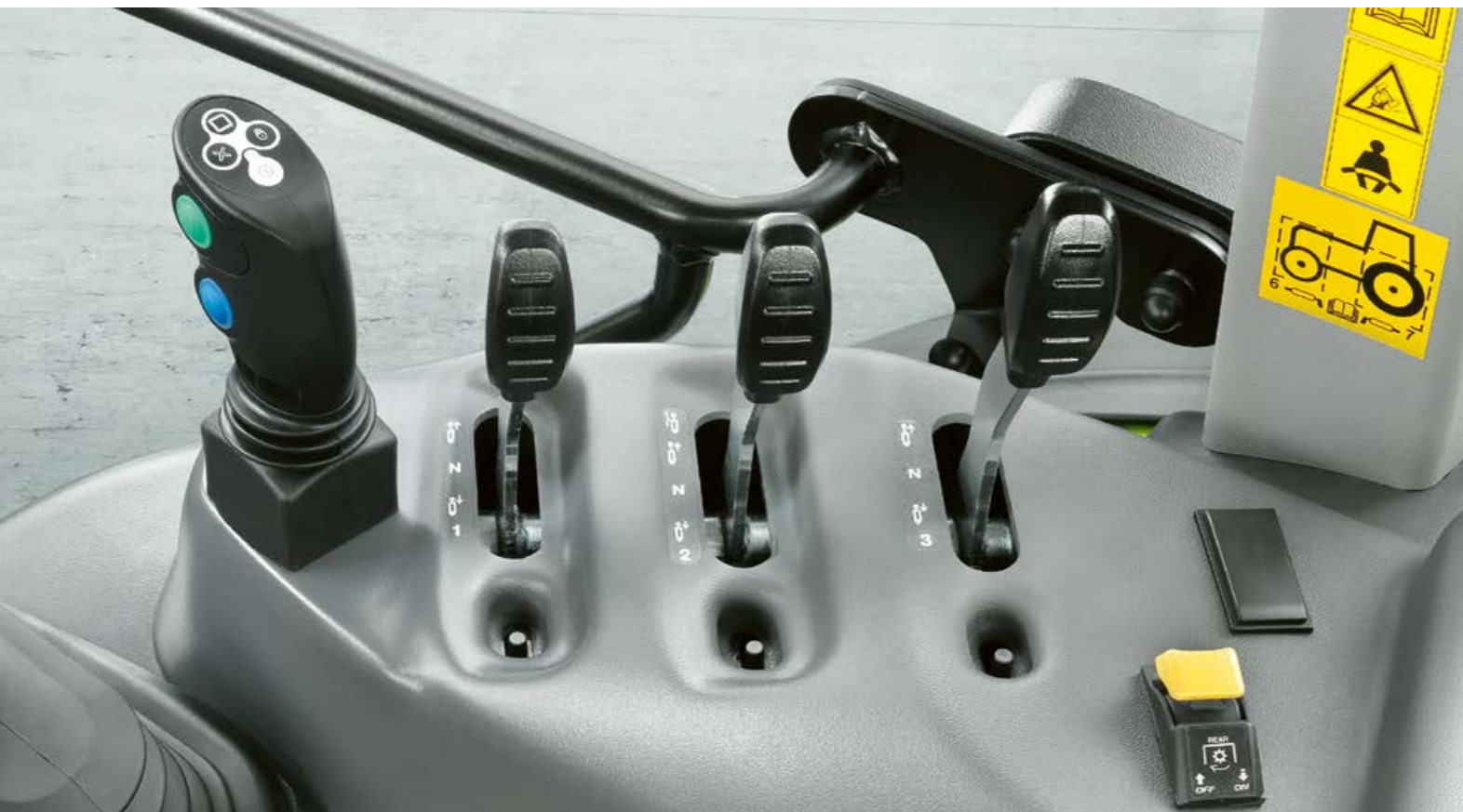
Die maximale Durchflussmenge des mechanischen Steuergerätes Nr. 3 kann mit einem Handgriff aus der Kabine begrenzt werden.
