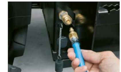
Rechts im Aufstieg finden Sie gut zugänglich die Batterie, das Werkzeugfach und einen Druckluftanschluss.
