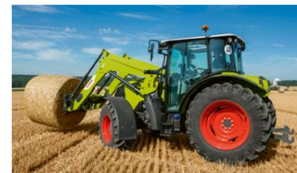
Im lenkwinkelabhängigen Modus wird die Lenkübersetzung im Geradeauslauf stark reduziert. Die Lenkung ist dann feinfühlig. Je stärker der Fahrer einlenkt, desto schneller reagiert die Lenkung. Ideal, um beispielsweise mit dem Frontlader zu arbeiten. Der Fahrer kann feinfühlig geradeaus und trotzdem schnell manövrieren.
