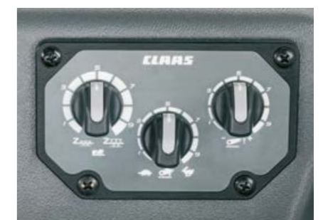
Le contrôle d'effort, la vitesse de descente et le réglage de la butée haute peuvent être réglés confortablement sur la console de droite.
