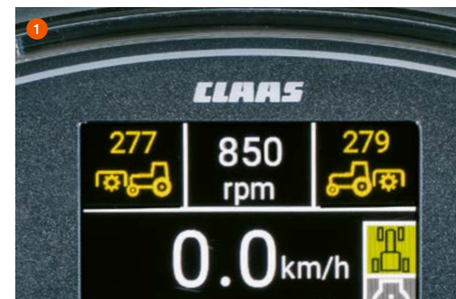
1 Grâce à l'affichage numérique du régime des prises de force avant et arrière, vous travaillez toujours au bon régime.
