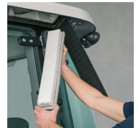
Facilement accessible depuis l'extérieur pour le nettoyage, le filtre à air de la cabine assure la continuité de l'alimentation en air frais de la cabine.
