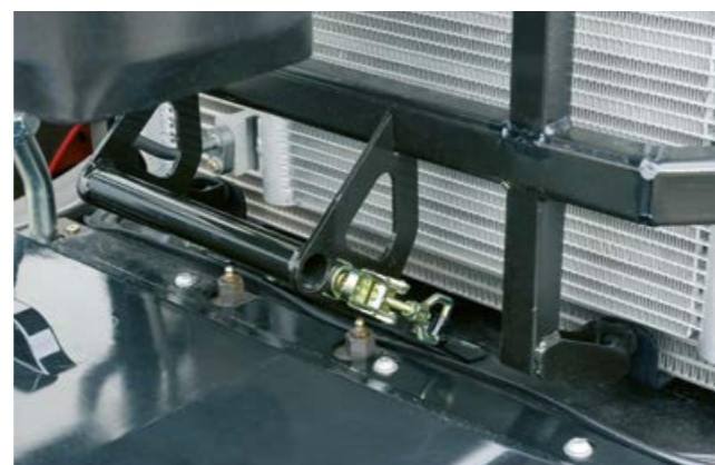
Schmierstellen der Vorderachse vor dem Kühlerpaket für eine optimale Erreichbarkeit.
