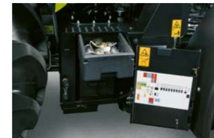
À droite du marchepied d'accès à la cabine, l'accès est optimal à la batterie, au coffre à outils et à une prise d'air comprimé.
