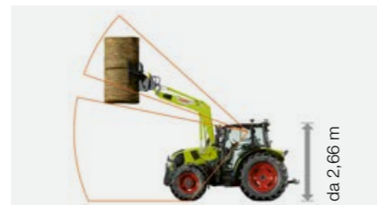
Cabina a tetto alto con botola trasparente nel tetto: altezza a partire da 2,66 m.
