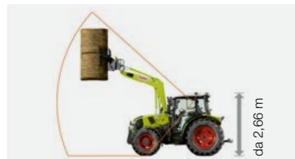
Cabina PANORAMIC con vetro anteriore monoblocco fino alla botola trasparente nel tetto: altezza a partire da 2,66 m.
