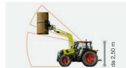
Cabina a tetto basso con botola trasparente nel tetto: altezza a partire da 2,50 m.
