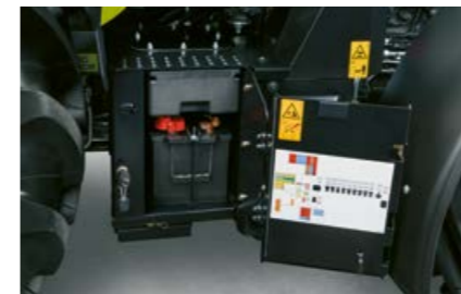
La batteria, il vano portattrezzi e un attacco per l'aria compressa sono posizionati a destra della scaletta d'accesso alla cabina.
