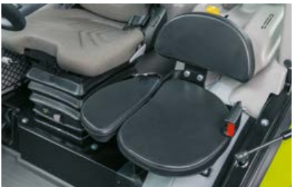
Die breite Sitzfläche bietet eine bequeme Fahrt auf dem Einweisersitz. Der integrierte Gurt mit Aufrollmechanismus sorgt für zusätzliche Sicherheit.
