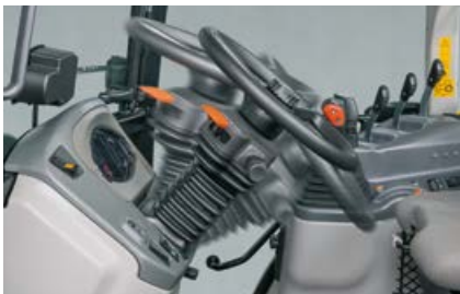
Eine komfortable Sitzposition erhält der Fahrer durch die verstellbare Lenksäule. Für eine optimale Fahrt lassen sich Neigung und Tiefe variieren.
