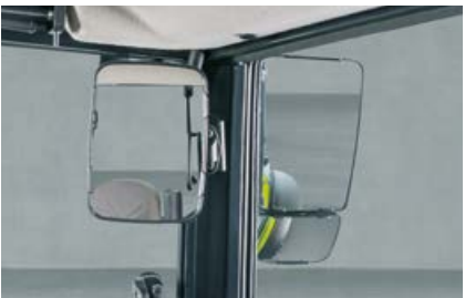
Zusätzlich zum großflächigen Spiegel ist ein Weitwinkelspiegel für mehr Sicherheit im Straßenverkehr verfügbar.
