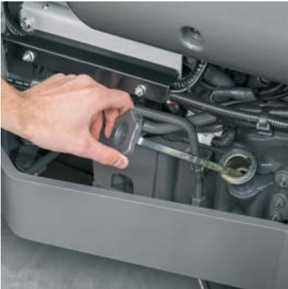
Ölstandskontrolle und Nachfüllen erfolgen bei geschlossener Haube an der rechten Seite des ELIOS 300.
