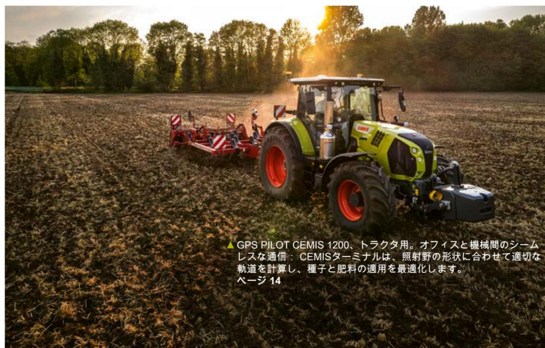
▲ GPS PILOT CEMIS 1200、トラクタ用。オフィスと機械間のシームレスな通信：CEMISターミナルは、照射野の形状に合わせて適切な軌道を計算し、種子と肥料の適用を最適化します。
