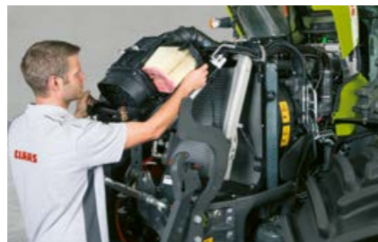
Zračni filter motora nalazi se ispred hladnjaka i lako se čisti.
