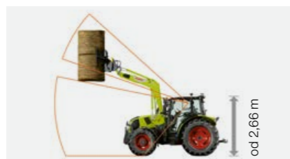
Kabina s visokim krovom sa staklenim krovnim prozorom: visina prolaza od 2,66 m.
