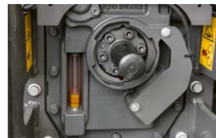
Poziom oleju przekładni można kontrolować przez wziernik obok WOM.
