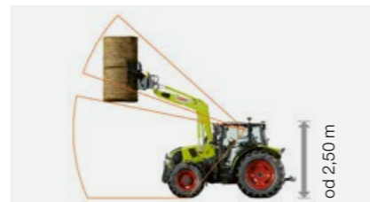
Kabina z dachem niskim z przeszklonym szyberdachem: wysokość do przejazdów powyżej 2,50 m.
