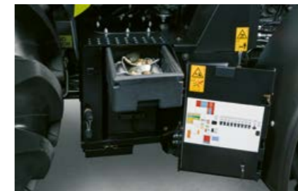
Отдясно на стъпалата ще намерите лесно достъпна батерия, отделение за инструменти и щуцер за подаване на сгъстен въздух.
