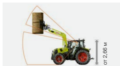
Кабина с висок покрив със стъклен люк на покрива: габаритна височина над 2,66 м.
