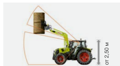
Кабина с нисък покрив със стъклен люк на покрива: габаритна височина над 2,50 м.
