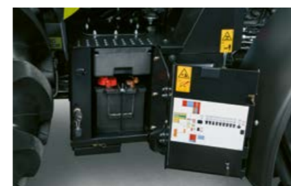
În partea dreaptă a treptelor se află bateria, compartimentul pentru scule și o conexiune pentru aer comprimat ușor accesibile.
