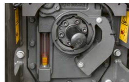
Nivelul de ulei hidraulic și de transmisie poate fi verificat cu ușurință utilizând fereastra de inspecție de lângă priza de putere.
