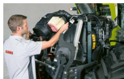
Filtrul de aer al motorului este amplasat în fața radiatorului și poate fi curățat cu ușurință.
