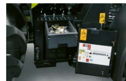
În partea dreaptă a treptelor se află bateria, compartimentul pentru scule și o conexiune pentru aer comprimat ușor accesibile.
