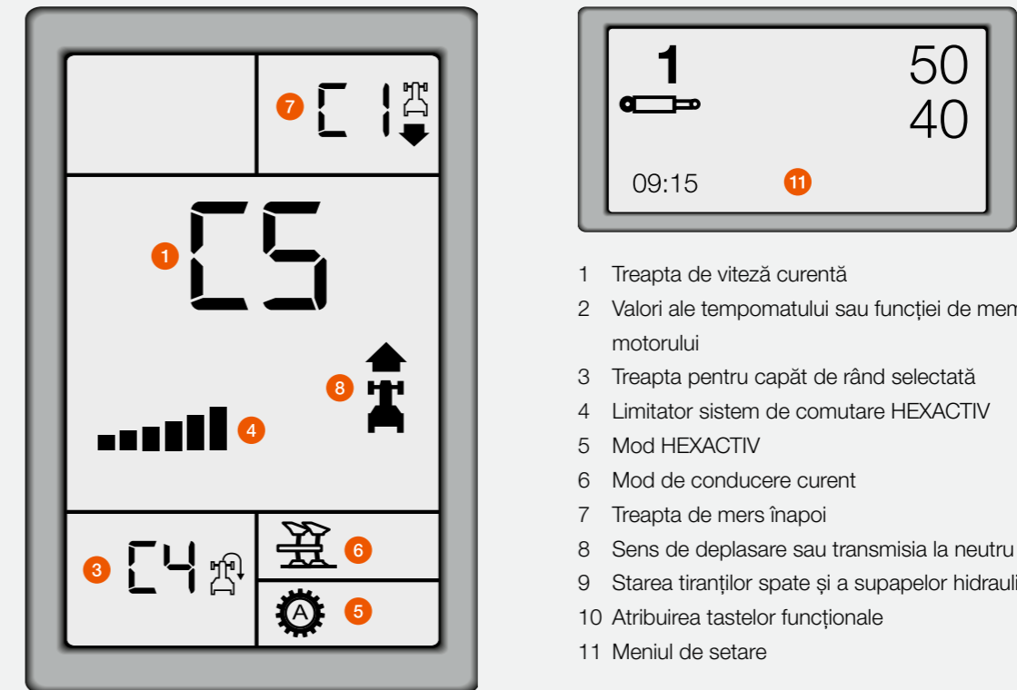
Afișaj CIS pe panoul de instrumente și afișaj pentru transmisie pe montantul A.
