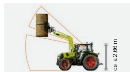
Cabină cu plafon înalt, cu trapă transparentă: înălțime de la 2,66 m.
