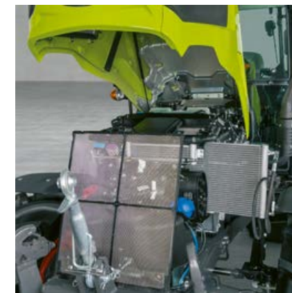
Im Handumdrehen lässt sich der Kühler herausziehen und das Kühlersieb zur Kontrolle und Reinigung entnehmen.
