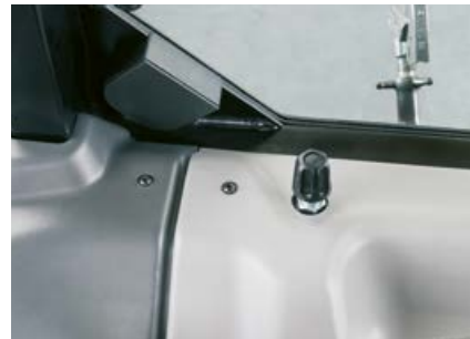
Die maximale Durchflussmenge des mechanischen Steuergerätes Nr. 3 kann mit einem Handgriff aus der Kabine begrenzt werden.
