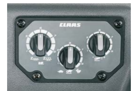
Zugkraftregelung, Senkgeschwindigkeit und Aushubbegrenzung stellen Sie komfortabel an der rechten Konsole ein.
