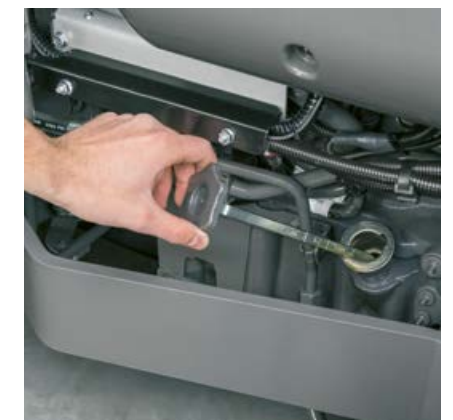
Ölstandskontrolle und Nachfüllen erfolgen bei geschlossener Haube an der rechten Seite des AXOS 200.
