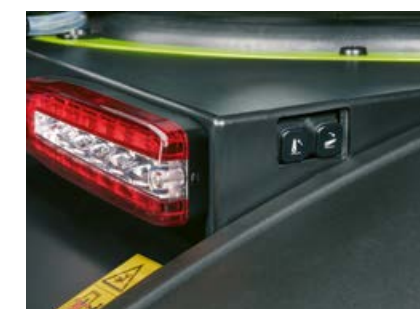
Den Heckkraftheber können Sie extern an beiden Heckkotflügeln bedienen.
