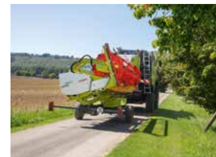
► Posizione di trasporto compatta con lame di taglio per colza montate.
